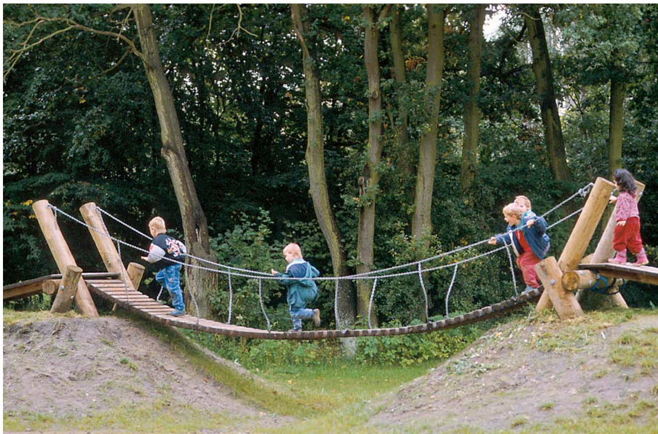
6.61000 grote hangbrug met hellende toegangspaden i.p.v. ladders
